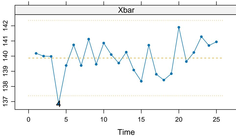
Emerge un allarme per il quarto turno di produzione. In effetti, ciò era dovuto a una maggiore viscosità delle resine registrata in quella giornata, dunque l'allarme segnalato era plausibilmente dovuto a un cambiamento reale nella qualità della produzione.
