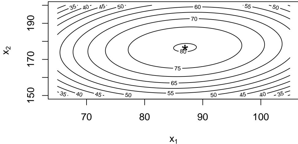
Calcolandoci il punto di massimo algebricamente, troviamo che la resa massima è in corrispondenza di  $X_1 \simeq 86.95m$ ,  $X_2 \simeq 176.5^{\circ}F$ , come si vede anche dalle curve di livello. Il risultato atteso è un raddoppio della resa di ogni ciclo di produzione rispetto alla situazione pre-esperimento (anche se la durata di un ciclo è aumentata).
