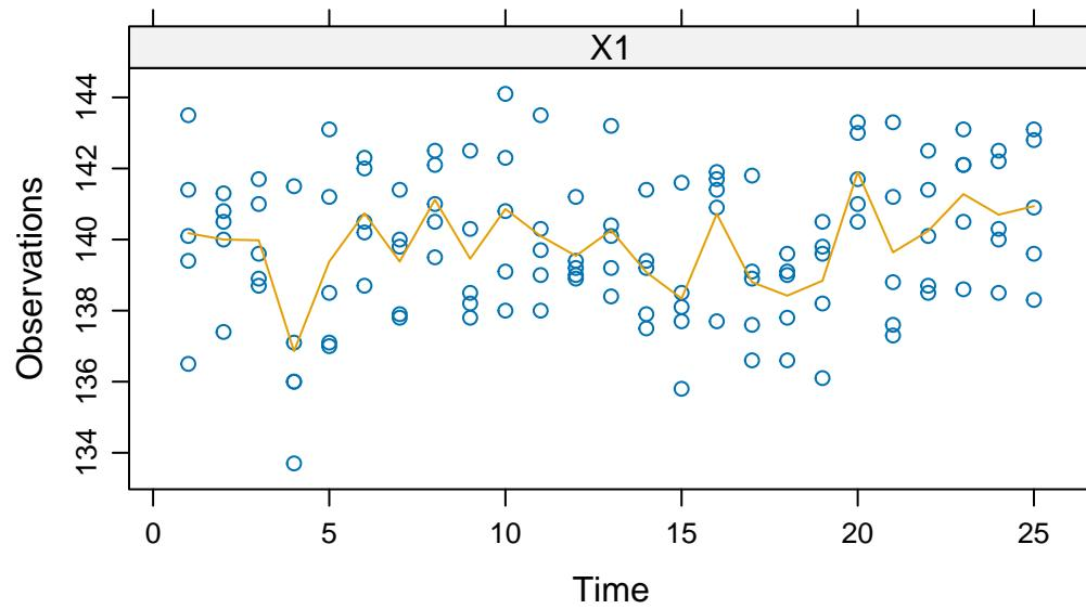
Assumendo normalità, calcoliamo e disegniamo i limiti di controllo di Shewhart a livello  $\alpha = 0.10$ .
