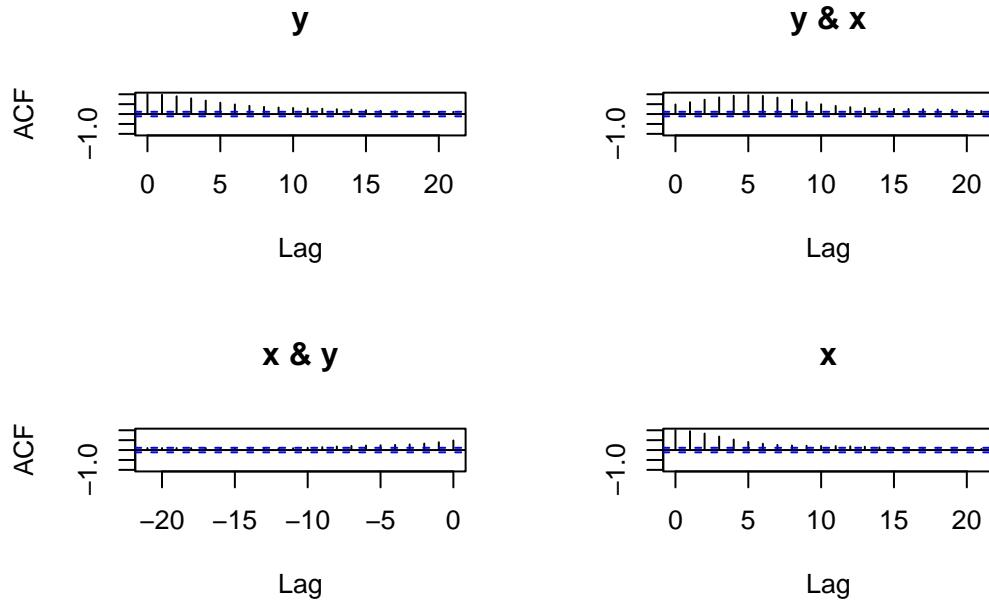
Si evidenzia forte autocorrelazione semplice e incrociata. Possiamo utilizzare un modello ARX(p,r) secondo cui il modello generatore dei dati è
